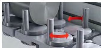
ILS-MUK 100 für die Zuführung großvolumiger, schwerer Werkstoffstangen
