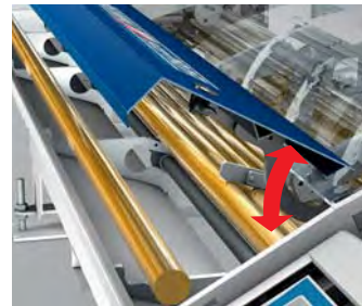
Die speziell konstruierte Ladeklapp ermöglicht das Nachladen der Werkstoffstangen ohne Maschinenstopp
